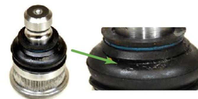
Guarda-pó danificado por não utilização do cone facilitador
